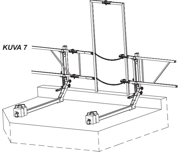
11. Porttielementin toinen puolikas kytketään yläorren liitäntholkilla ja kiristetään paikoilleen. Portin välittömään läheisyyteen on asennettava tukijalka. (katso kuva 7)
