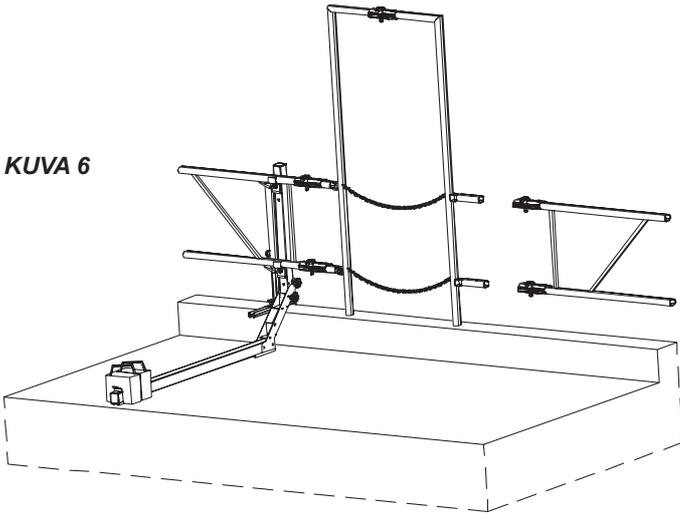
10. Kulkuportti asennetaan kuten aitaelementti. Porttielementin puolikas asennetaan aitaelementin liitäntholkkeihin ja kiristetään paikoilleen (katso kuva 6)
