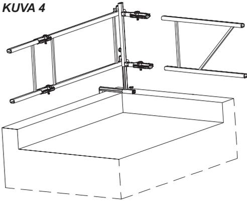
8. Katon kulmaan asennetaan kulmanivel aitaelementin päälle. Kiristä se ja säädä kulmanivelen korkeus ja etäisyys. (katso kuva 4)
