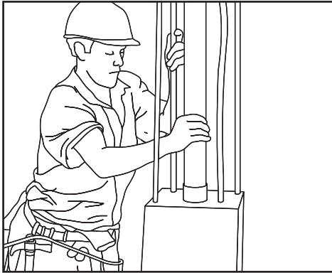
Kuva 9. Nosta osat valettuun putkeen.
