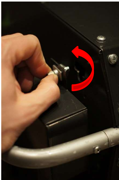
1. Kierrä anturikotelon lukitusruuvia vastapäivään. Tarvittaessa käytä ruuvimeisseliä.
