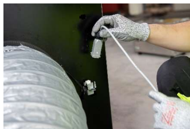
7. Tämän jälkeen voit liittää lisävarusteena olevan jatko kaapelin toisen pään paineentasaimen liitinrasiiaan, ja toisen pään paine-eroanturin liittimeen. Vakiomittainen jatkojohto 20m (lisävaruste).
