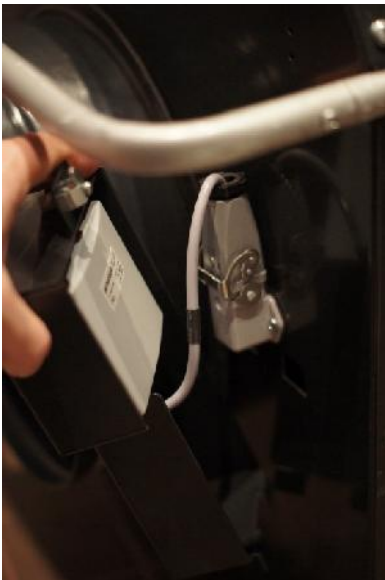
3. Nostettuasi kotelon paikaltaan anturin sähköliitin tulee näkyviin.
